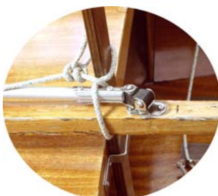
Die Pinne wird an der Baumstütze fest verknotet
