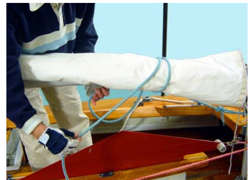
Die Schleppleine wird in Luftmaschen um das ausgerollte Segel gewickelt
