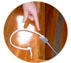
Bei stärkerem Wind muss der Ausreitgurt eingestellt und in der Klemme gesichert werden
