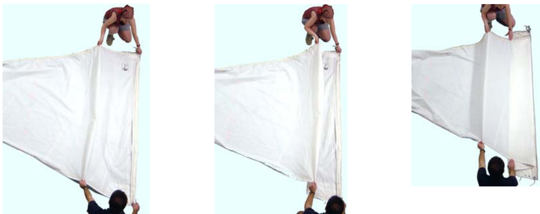
Das ausgelegte Segel wird ziehharmonikaförmig und faltenfrei aufeinander gelegt
