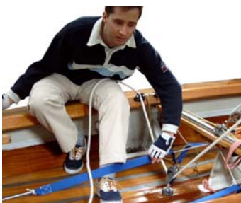
Grossschot am Fußblock fassen
