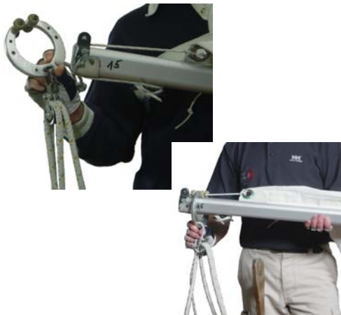
Überstreifen des Schotrings
