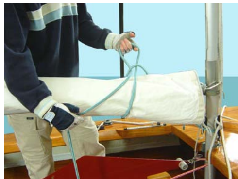
Die Schleppleine wird in Luftmaschen um das ausgerollte Segel gewickelt
