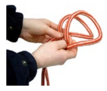
zweites Auge über das erste Auge legen, Tampen müssen 'innen' liegen
